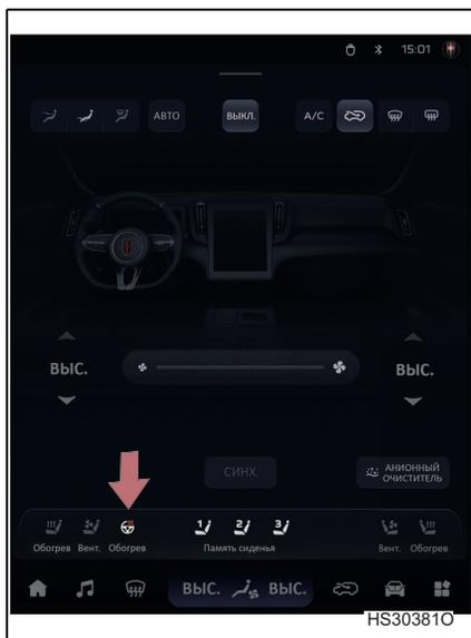
Нажмите кнопку обогрева рулевого колеса в интерфейсе настройки системы кондиционирования воздуха на мультимедийном дисплее. Кнопка загорится, и включится функция обогрева рулевого колеса. При повторном нажатии кнопки функция обогрева рулевого колеса выключится.
