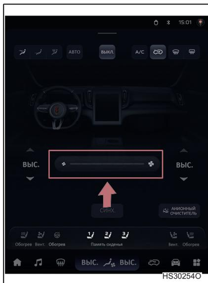
Нажмите кнопку настройки объема подачи воздуха на дисплее или проведите по полосе настройки объема подачи воздуха, чтобы отрегулировать объем подачи воздуха в систему кондиционирования воздуха автомобиля на уровне от 1 до 7.
