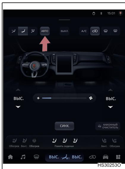
При нажатии на дисплее кнопки [АВТО] загорится индикатор работы и произойдет переход в автоматический режим системы кондиционирования воздуха, в котором можно выбирать предпочтительный уровень режима.
