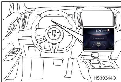
Когда система распознает знак ограничения скорости, а скорость автомобиля при этом меньше значения ограничения, на комбинации приборов отобразится только текущее требуемое ограничение скорости при помощи индикатора, но если скорость автомобиля больше значения ограничения, комбинация приборов уведомит водителя о превышении ограничения с помощью звукового сигнала / значка / текстового сообщения и т. д.
