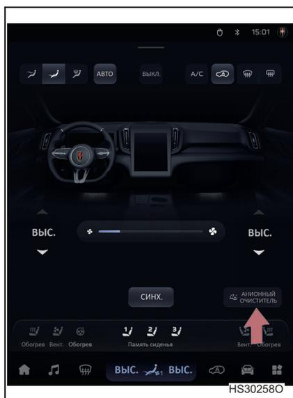
При нажатии кнопки ионизации на дисплее загорится индикатор и включится функция ионизации воздуха. При повторном нажатии индикатор погаснет и функция выключится.
