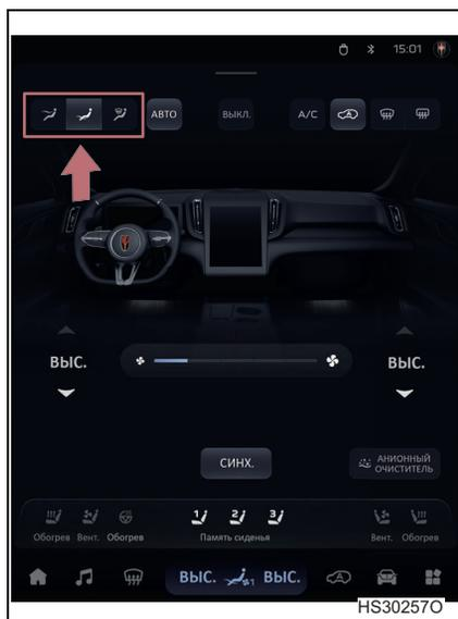
Нажмите кнопку выбора режима потока воздуха, чтобы выбрать соответствующий режим. При повторном нажатии кнопки режим потока воздуха будет отменен. Режимы можно сочетать при выборе.
