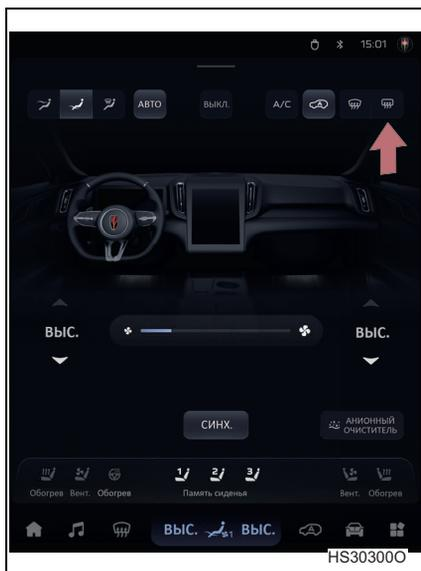
При нажатии кнопки
