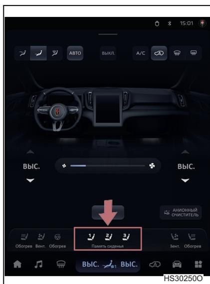
Чтобы установить содержимое памяти: после регулировки положения сиденья и наружного зеркала заднего вида нажмите любую кнопку памяти более чем на 3 секунды. Отпустите кнопку после того, как услышите звуковой сигнал комбинации приборов, при этом информация о положении будет сохранена в памяти.
