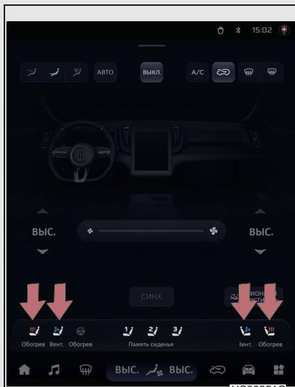
Нажмите кнопку обогрева и вентиляции сиденья на интерфейсе настройки системы кондиционирования воздуха на мультимедийном дисплее и выберите необходимый уровень обогрева или вентиляции.
