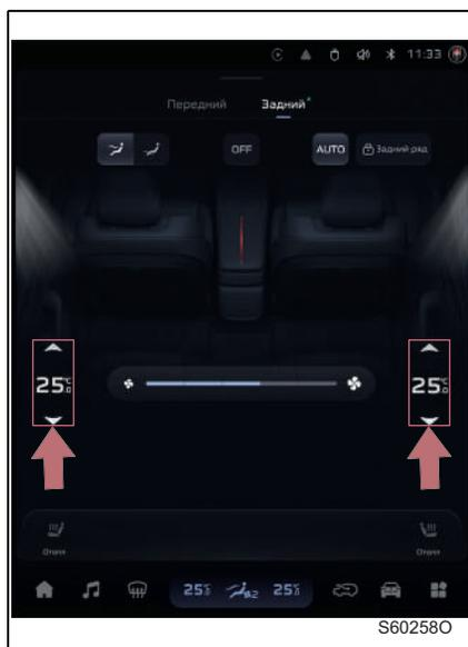
Нажмите кнопку настройки температуры  $\wedge$  (увеличение температуры) или  $\vee$  (уменьшение температуры) на интерфейсе управления системы кондиционирования воздуха или проведите по значению на дисплее температуры вверх или вниз.
