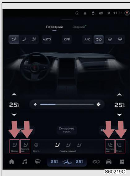
Нажмите кнопку обогрева и вентиляции сиденья на интерфейсе настройки системы кондиционирования воздуха на мультимедийном дисплее и выберите необходимый уровень обогрева и вентиляции.
