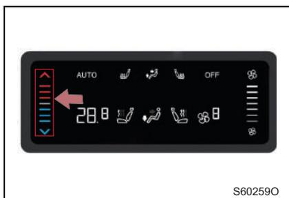
Способ 2: чтобы установить температуру, нажмите кнопку настройки температуры на панели управления.
