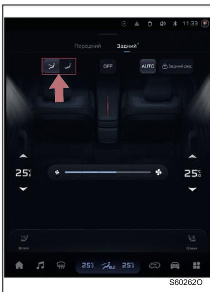
Способ 1: Нажмите на индикатор направления потока воздуха, чтобы выбрать соответствующий режим. При его повторном нажатии режим потока воздуха отменяется. Режимы потока воздуха можно сочетать при выборе.
