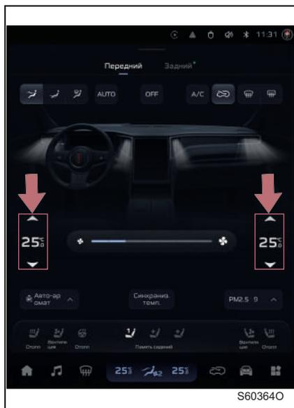
Чтобы установить температуру, нажмите кнопку настройки температуры  $\wedge$  (увеличение температуры) или  $\vee$  (уменьшение температуры) на интерфейсе управления системы кондиционирования воздуха или проведите по значению на дисплее температуры вверх или вниз.
