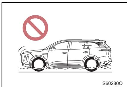
При движении по затопленной дороге может заглохнуть двигатель, может произойти короткое замыкание электрических компонентов, попадание воды внутрь и т. д. Не пытайтесь запустить заглохший двигатель. Это может привести к его серьезному повреждению.
