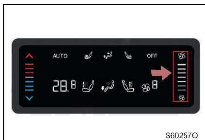
Способ 2: Чтобы отрегулировать объем подачи воздуха в систему кондиционирования воздуха заднего ряда на уровне от 1 до 7, надо нажать кнопку настройки объема подачи воздуха на панели управления.
