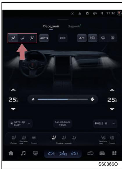
Нажмите на индикатор направления потока воздуха, чтобы выбрать соответствующий режим. При его повторном нажатии режим потока воздуха отменяется. Режимы потока воздуха можно сочетать при выборе.
