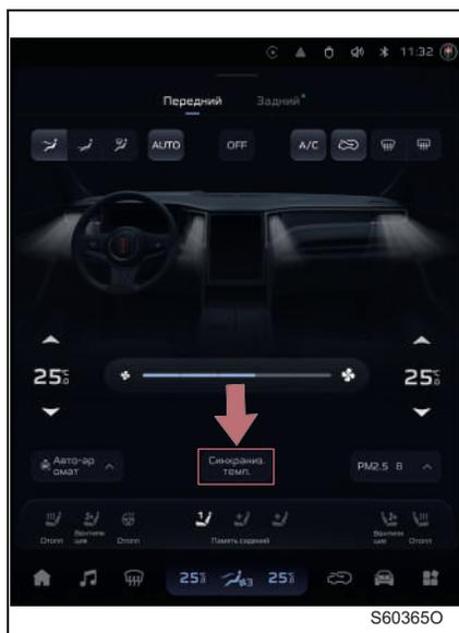
При нажатии кнопки [Синхронизация температуры] загорится индикатор, включится режим управления с одной температурной зоной, и температура на стороне переднего пассажира и на заднем ряду будет синхронизирована с температурой, установленной на стороне водителя.
