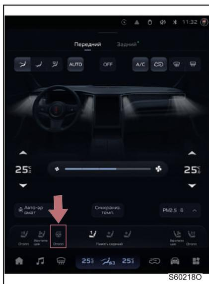
При нажатии кнопки обогрева рулевого колеса на интерфейсе настройки системы кондиционирования воздуха на мультимедийном дисплее кнопка загорится и включится функция обогрева рулевого колеса. При повторном нажатии кнопки функция обогрева рулевого колеса выключится.
