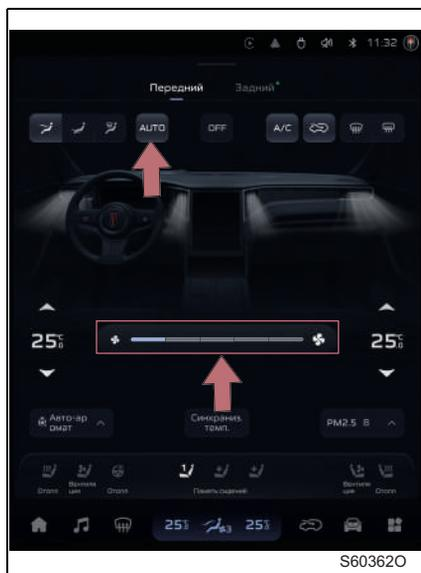
При кратковременном нажатии кнопки [AUTO] на интерфейсе управления системы кондиционирования воздуха, передняя система кондиционирования переключится в автоматический режим; при долговременном нажатии кнопки [AUTO] система кондиционирования воздуха автомобиля переключится в автоматический режим.
