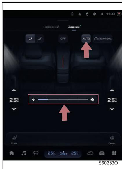
Способ 1: При нажатии кнопки [АВТО] на интерфейсе управления системы кондиционирования воздуха включится автоматический режим кондиционирования. В автоматическом режиме кондиционирования воздуха пользователь может выбрать предпочтительный уровень режима от 1 до 5: уровень 1 — плавный поток воздуха, уровень 2 — средний плавный, уровень 3 — средний, уровень 4 — средний сильный, уровень 5 — сильный поток воздуха.
