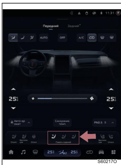
Для сохранения информации в памяти: после регулировки положения сиденья, рулевого колеса и наружного зеркала заднего вида нажмите любую кнопку памяти сиденья на интерфейсе настройки системы кондиционирования воздуха на мультимедийном дисплее (более чем на 3 секунды), чтобы сохранить информацию о положении на этой кнопке.
