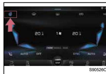
Коснитесь кнопки обогрева рулевого колеса на панели настройки кондиционера, загорится индикатор, включите функцию обогрева рулевого колеса и нажмите ее еще раз, чтобы отключить функцию обогрева рулевого колеса.
