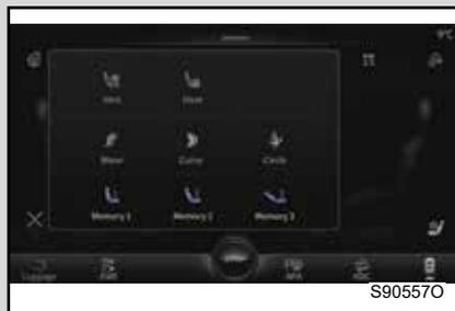
Нажмите кнопку настройки сиденья на передней панели управления кондиционером, чтобы войти в интерфейс настройки сиденья; нажмите кнопку обогрева и вентиляции сиденья и выберите соответствующий режим обогрева и вентиляции.
