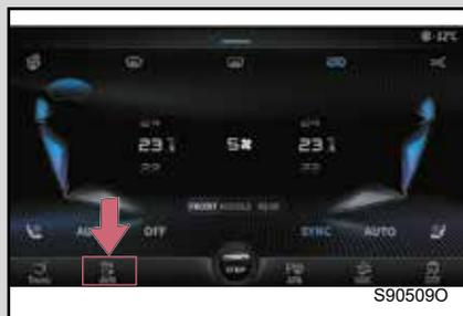
Когда скорость автомобиля ниже 15 км/ч, нажмите кнопку переключения радара/изображения, кнопка загорится и включится парковочный радар; нажмите кнопку переключения радара/изображения снова, кнопка погаснет и парковочный радар выключится.
