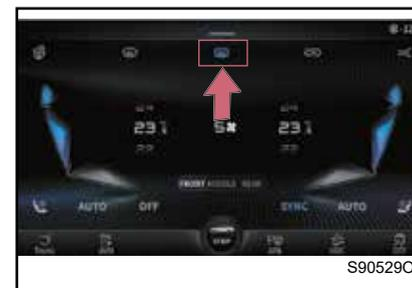
Если зеркало заднего вида запотело, коснитесь кнопки обогрева заднего стекла на панели управления кондиционером, чтобы одновременно обогреть наружное зеркало заднего вида и заднее стекло; нажмите кнопку еще раз, чтобы отключить обогрев.
