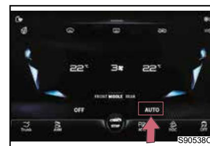
Метод I. Нажмите кнопку [AUTO] на операционном дисплее кондиционирования воздуха, загорится индикатор, и включится автоматический режим кондиционирования воздуха.
