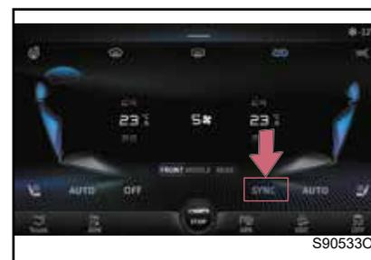
При касании кнопки [SYNC] загорается индикатор и включается режим управления одной температурной зоной, при этом зона со стороны пассажира и зона второго ряда синхронизируются с температурой и режимом потока воздуха, установленными на стороне водителя.
