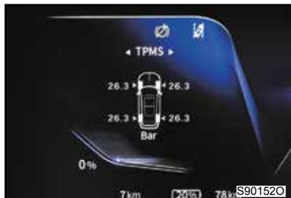
При падении давления в шинах низкое давление в шине отображается желтым цветом, нормальное давление в других шинах отображается зеленым цветом.
