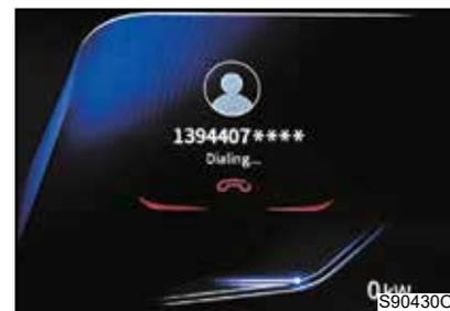
При поступлении входящего вызова нажмите и удерживайте кнопку телефона на рулевом колесе, чтобы отклонить вызов; во время разговора нажмите кнопку телефона на рулевом колесе, чтобы завершить звонок.
