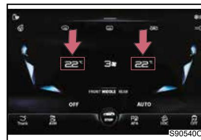
Метод I. Сдвиньте значение настройки температуры на операционном дисплее кондиционера вверх и вниз, чтобы установить температуру.
