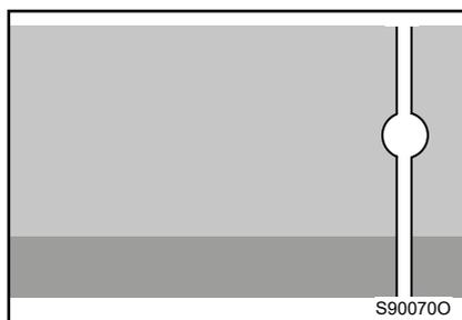
Если на камеру попадает сильный свет (например, солнечный свет, отраженный от кузова автомобиля), это может вызвать эффект блика, уникальный для камер заднего вида <sup>\*1</sup>.
