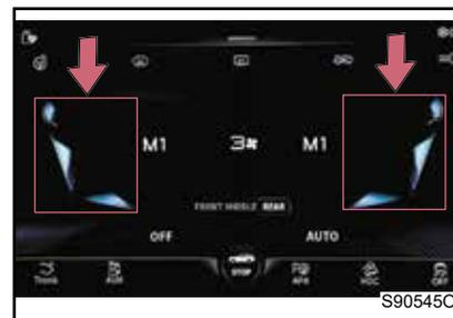
Метод I. При прикосновении к указателю потока можно выбрать соответствующий режим потока воздуха, при повторном нажатии можно отменить данный режим потока воздуха.
