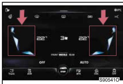
Метод I. При прикосновении к указателю потока можно выбрать соответствующий режим потока воздуха, при повторном нажатии можно отменить данный режим потока воздуха.
