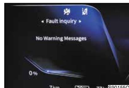
В случае возникновения неисправности информация появится в виде всплывающего окна. Информацию также можно просмотреть на дисплее через интерфейс запроса неисправности.
