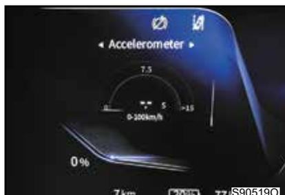
Колесико прокрутки на рулевом колесе позволяет переключаться между информацией об ускорении от 0 до 100 км/ч и информацией о направлении ускорения.
