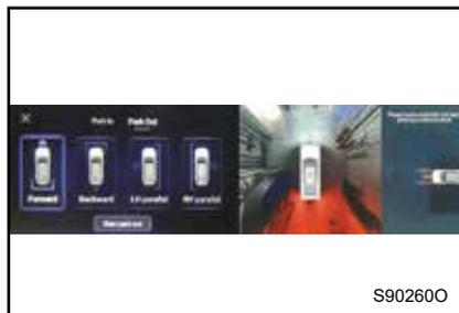
На мультимедийном дисплее можно выбрать четыре вида выезда: вертикально назад, вертикально вперед, параллельно влево, параллельно вправо.
