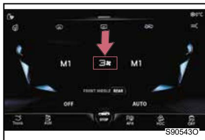
Метод I. Проведите вверх и вниз по значению установки объема воздуха на экране дисплея переднего кондиционера, чтобы выполнить регулировку объема воздуха по шкале от 1 до 5 для кондиционера третьего ряда.
