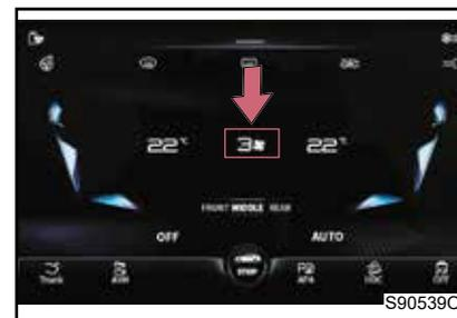
Метод I. Сдвиньте значение настройки объема воздуха на операционном дисплее кондиционирования воздуха вверх и вниз, чтобы осуществить регулировку объема воздуха в системе кондиционирования воздуха на уровнях 1–7.
