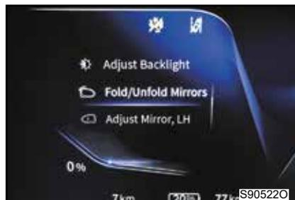
Коротко нажмите кнопку меню на рулевом колесе, чтобы войти в интерфейс настройки яркости подсветки и внешних зеркал заднего вида. Яркость подсветки и внешние зеркала заднего вида (складывание/раскладывание, угол наклона) можно настроить с помощью колесика прокрутки на рулевом колесе и кнопки выбора влево/право.
