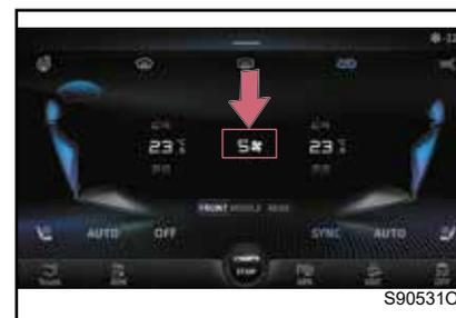
Установка значения объема воздуха вверх и вниз путем регулировки системы интенсивности вентиляции по шкале от 1 до 7.
