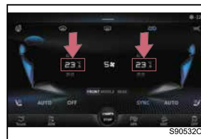
Установка значения температуры вверх и вниз производится регулировкой температуры. Температуру со стороны водителя и со стороны пассажира можно регулировать отдельно.
