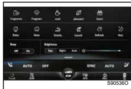
После выбора подходящего режима ароматическая система улучшит окружающую среду в автомобиле с помощью кондиционера и улучшит комфорт водителя и пассажиров.
