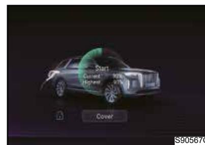
Когда автомобиль находится в состоянии ожидания регулярной зарядки, нажмите кнопку [Старт] на интерфейсе зарядки мультимедийной системы, можно немедленно начать зарядку переменным током, не выключая переключатель регулярной зарядки.
