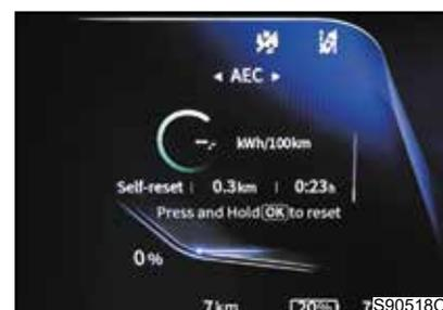
Отображает среднее потребление энергии/пробег/время работы автомобиля с момента самостоятельной перезагрузки. Нажмите и удерживайте колесико прокрутки на рулевом колесе для сброса значений среднего потребления энергии/пробега/времени работы.
