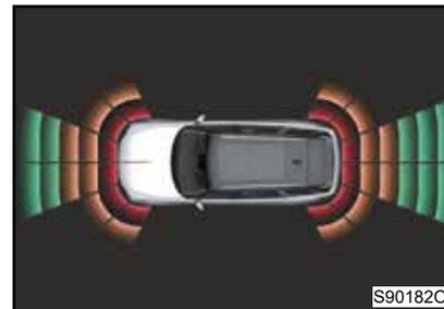
Когда радарный датчик обнаруживает препятствие, на мультимедийном дисплее отображается соответствующее изображение в зависимости от местоположения препятствия и расстояния до него. Зона замедленного действия, зона предупреждения и опасная зона отображаются соответственно зеленым, желтым и красным цветом.
